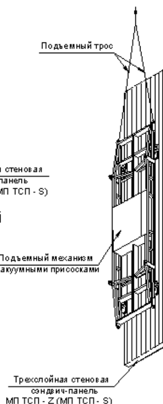
Схема строповки при вертикальной раскладке сэндвич-панелей
